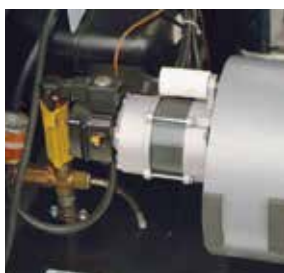
En-faset motor koblet til vifte og dieselpumpe
